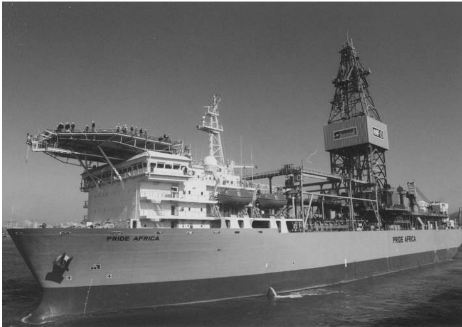
Figuur 4 Een dynamisch gepositioneerd boorschip dat tot op 3000m waterdiepte putten kan boren.
