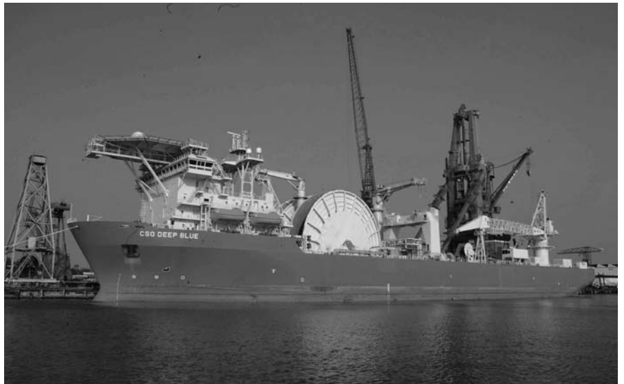
Figuur 1 Een schip geschikt om op zeer diep water pijpleidingen te leggen.
