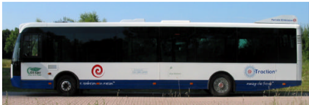
Figuur 4: The Whisper, met duidelijk in plaats van een conventioneel achterwiel, de elektromotor
