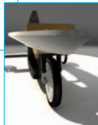
Het kantellichaam: een erg stevig en rekbaar rubber verbindt het zonnepaneel met het frame. Zo wordt er geen wind gevangen. Het thermoplastische elastomeer kan tot 600 procent uitrekken, maar voor deze constructie is slechts 200 procent nodig.
