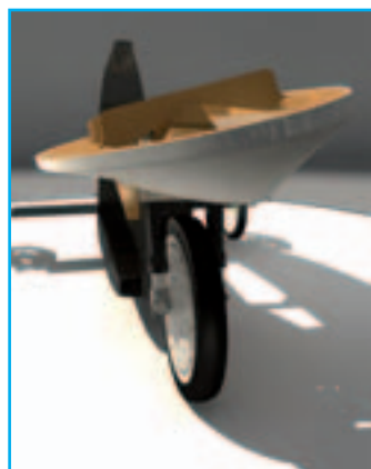
Het kantellichaam: een erg stevig en rekbaar rubber verbindt het zonnepaneel met het frame. Zo wordt er geen wind gevangen. Het thermoplastische elastomeer kan tot 600 procent uitrekken, maar voor deze constructie is slechts 200 procent nodig.
