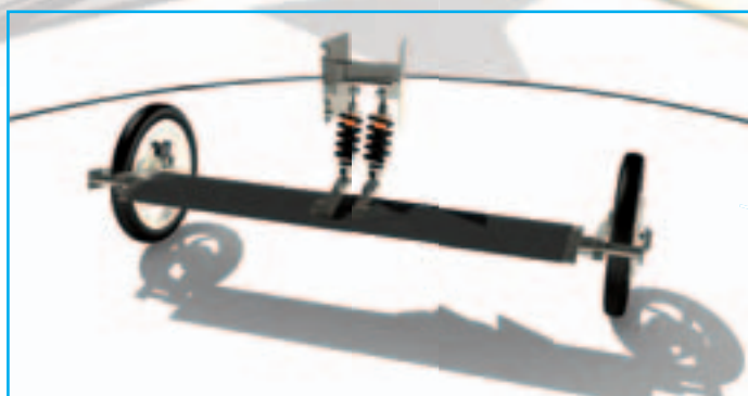
Twee veren moeten de krachten opvangen waaraan de uit slechts een vleugel bestaande achterwielophanging wordt blootgesteld.
