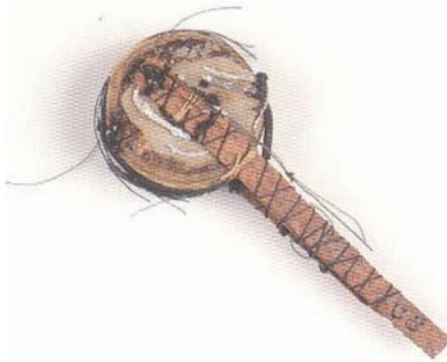
Figuur 10: Klosje met looddraad dat in Leiden is gebruikt voor experimenten aan supergeleidende magneetspoelen (uit Dirk van Delft: Jacht op het absolute nulpunt, uitg. Bert Bakker, 2008)
