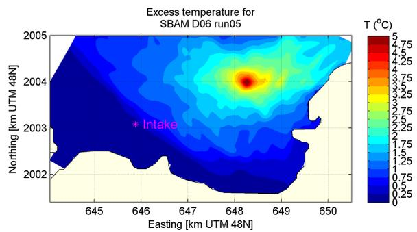
(d) Maximum temperature in surface layer,  $Q=70m^3/s$
