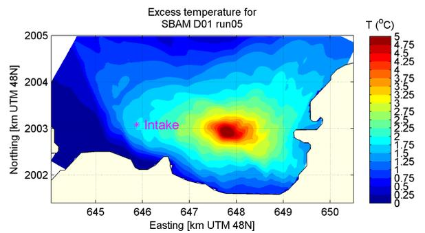
(d) Maximum temperature in surface layer,  $Q=70m^3/s$
