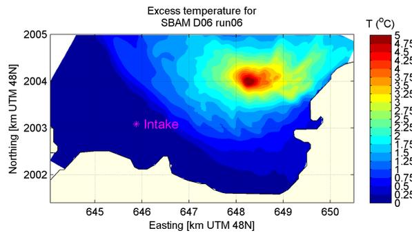
(d) Maximum temperature in the surface layer,  $Q=170m^3/s$
