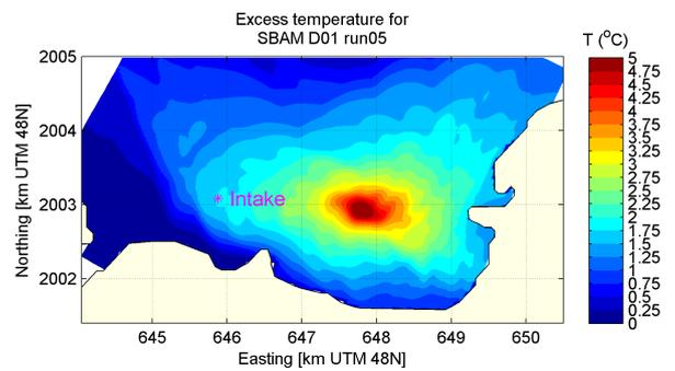
(d) Maximum temperature in surface layer,  $Q=70m^3/s$
