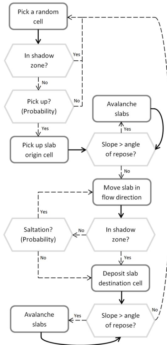
FIGURE 6: BASIC RULES OF THE CELLULAR AUTOMATON DUNE MODEL
