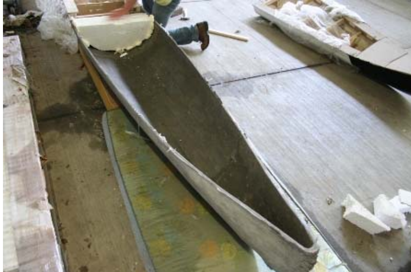
Figuur 16 – Het ontkisten van de kano. Het middenstuk en de boeg zijn reeds verwijderd.
