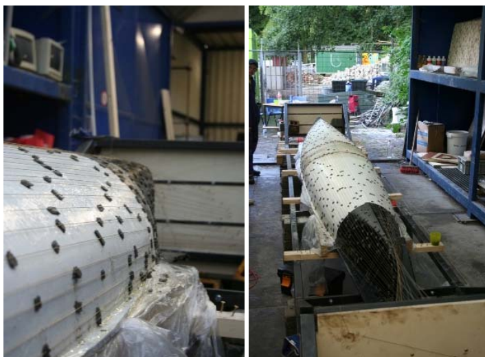
Figuur 13 – Afstandhouders ‘at work’. In detail (links) en gezien over de hele mal.
