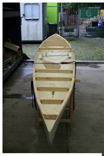
Figuur 8 – Het houten raamwerk
