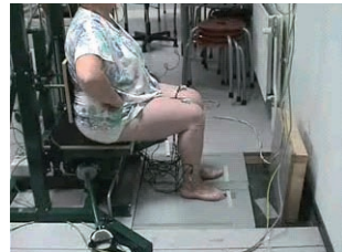
Figuur 11: De meetopstelling om de functionaliteit van patiënten met een knieprothese te bepalen.
