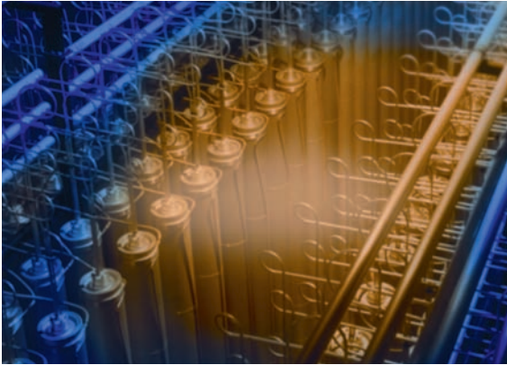
Figuur 4: Cascade van ultracentrifuges in een verrijkingsfabriek
