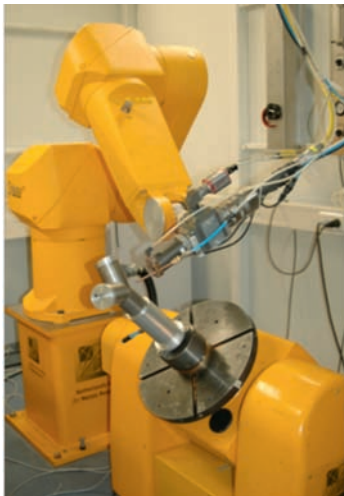
Figuur 33: Laserlassen van complexe lasnaden met acht-assige laserlascel
