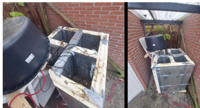
Figuur 2 - De proefopstelling: drie bakken met een binnenmaat van 30 bij 30 cm en een hoogte van 110 cm. Het geheel is geïsoleerd met PIR platen en staat onder een afdakje. De sensorunit staat onder de emmer ter bescherming voor regen.
