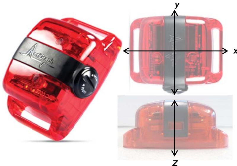
Figuur 3. Aanzichten van de GT3X+ met de assen [81].
