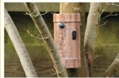
In het Reyeroordpark komen 23 infraroodsensoren bij de ingangen van het park. De sensoren meten of iemand voorbijloopt. Elk uur worden de gegevens verzonden naar de leverancier van de sensoren.
