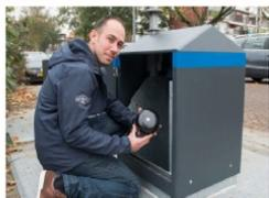
In de afvalbak zit een sensor die met sonar meet hoe vol de bak zit. De sensor is niet zichtbaar. De gegevens van de sensor worden twee keer per dag verzonden naar de leverancier van de sensoren.
