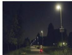
Aan de lantaarnpalen in Reyeroord zit een bewegingssensor om te meten of iemand in de buurt is. Als er iemand in de buurt is, gaat de lantaarnpaal aan. Hiermee besparen we energie.
