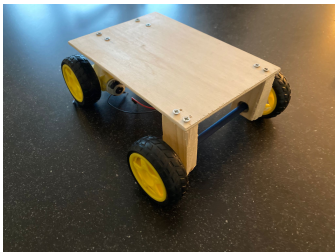
Figure 15: Multiplex plaat met bevestigde motoren, as en vier wielen
