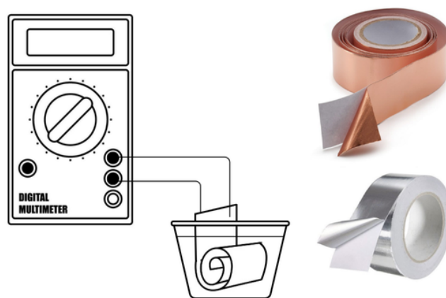
Figure 8: Ontwerp batterij met tape (links) en koper- en aluminiumtape (rechts)
