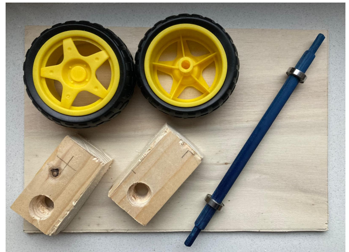
Figure 12: Multiplex plaat en blokjes, geschuurde as met kogellagers en wielen
