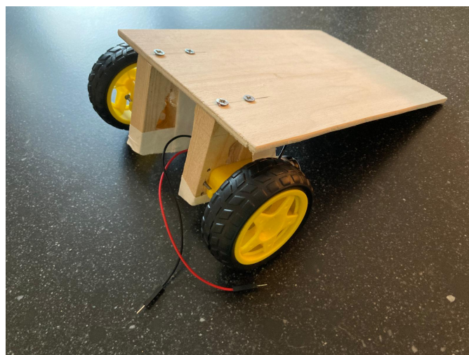
Figure 14: Multiplex plaat met bevestigde motoren
