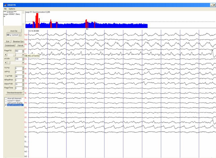
Fig. 10. Screen dump van user interface zoals gerealiseerd door Stam et al. voor real-time detectie van epileptiforme afwijkingen. De events met rood aangegeven duiden op aanwezigheid van epileptiforme afwijkingen.
