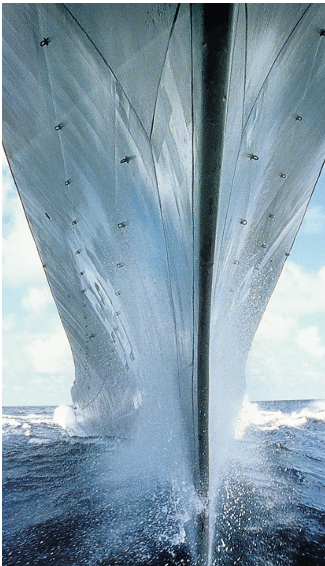
Coatings met nanotechnologie voorkomen algenaan groei op de wanden van schepen.
