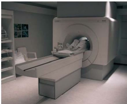
Figuur 5: Magnetic Resonance Imaging (MRI) apparaat, werkend met supergeleidende magneten, en MRI-scan van een hoofd [7].
