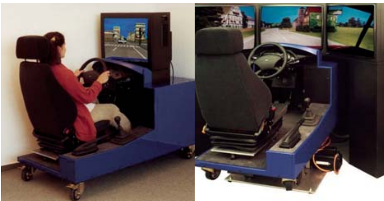
Figuur 3 Eenvoudige ("cost-effective") rijsimulatoren ontwikkeld in het EU Trainer project.
