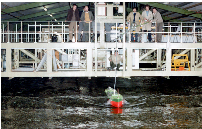
FIGUUR 10 Proeven bij het MARIN: 5% brandstofbesparing aangetoond
