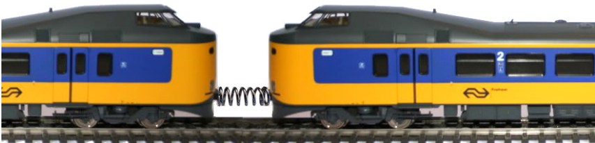
FIGUUR 20 Alternatief koppelmechanisme: virtuele veer
